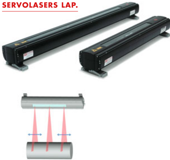
SERVOLASER operando con un modulo de laser de línea fijo y dos móviles
