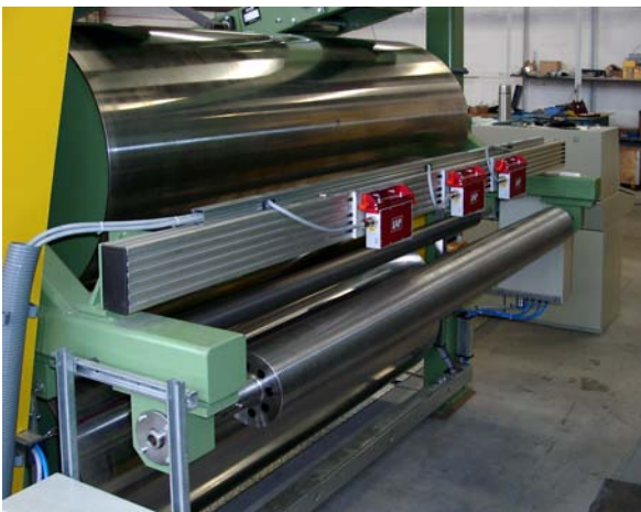
Dreispurige Dickenmessung an einem Berstoff Kalandrier
