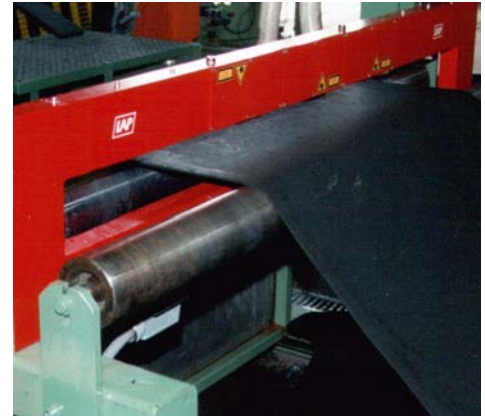
Dreispurige Dickenmessung bei CWW
