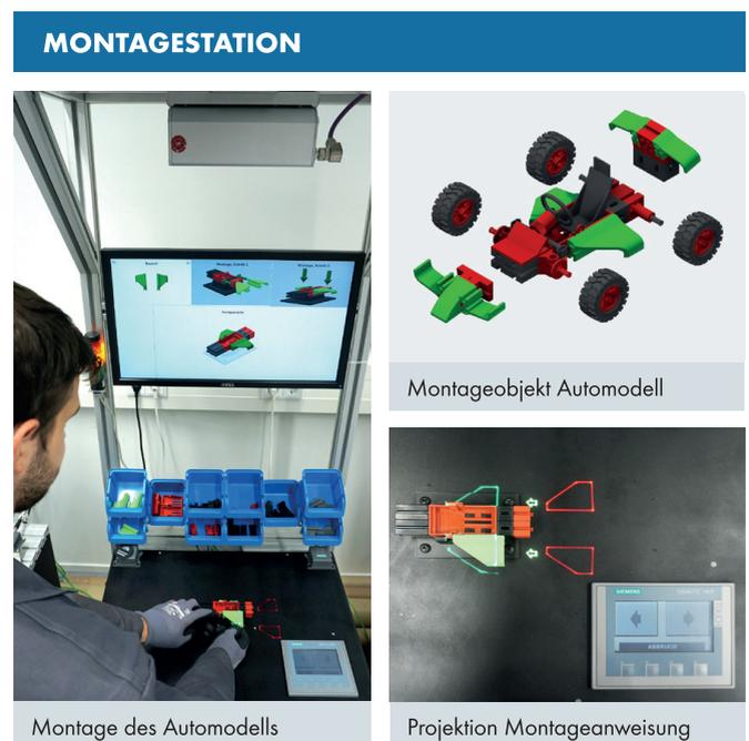
**Bild 3: Montage des Automodells mithilfe des Laser-Assistenzsystems.**
