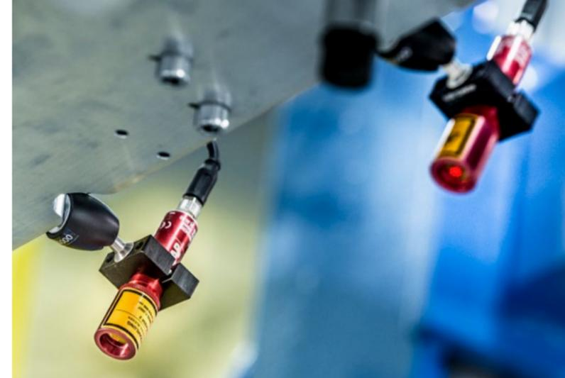
Verbauung auf engstem Raum: LAP LD Punktlaser installiert am Oberwerkzeug der Press-Kaschieranlage
