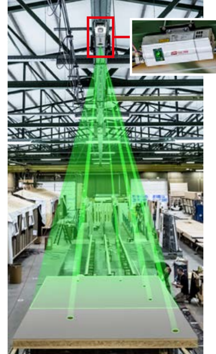
Das CAD-PRO Laserprojektionssystem projiziert auch aus mehreren Metern Entfernung präzise Umrissbeispiele, wie hier auf Flachdachelemente.
