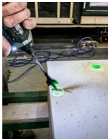
Projizieren und bohren – die sekunden-schnelle Anzeige der Bohrlöcher spart wertvolle Produktionszeit.
