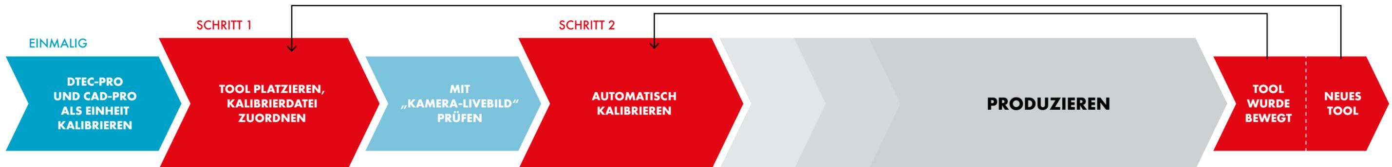
Mit der Funktion „Einheitenkalibrierung“ können ein oder mehrere DTEC-PRO mit einem oder mehreren CAD-PRO als Einheit kalibriert werden. Tools und deren Targets im Bereich der Einheit werden gemeinsam erkannt und behandelt.
