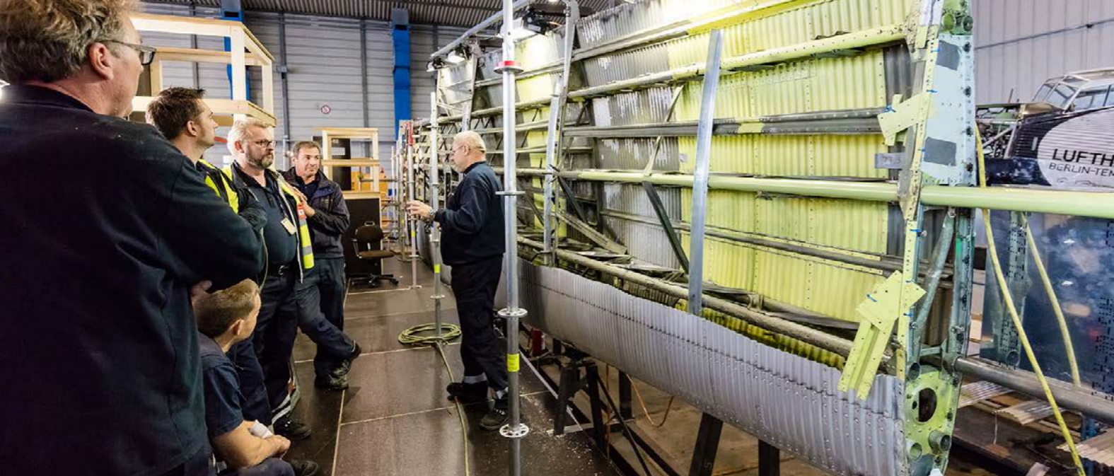
Dans le hangar de la base Lufthansa de Hambourg, le Ju a revêtu six nouveaux longerons d'aile. Chaque longeron mesure 11 mètres de long et se compose de six à huit tubes segmentés, dont le diamètre va rétrécissant jusqu'à l'extrémité des ailes.
